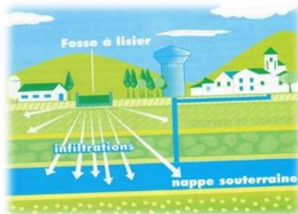
Figure 14. Contamination des eaux souterraines par une fosse à lisier fissurée
